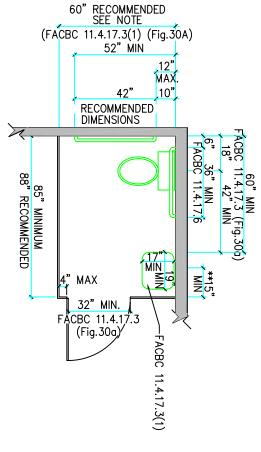
\*\* THE SINK SHALL BE A MINIMUM OF INCHES FROM THE SIDE WALL AS REQUIRED BY SECTION P405.3.1 OF FPC. 15
